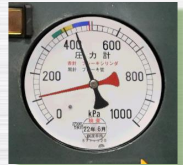
ブレーキ操作時の圧力計の表示例
