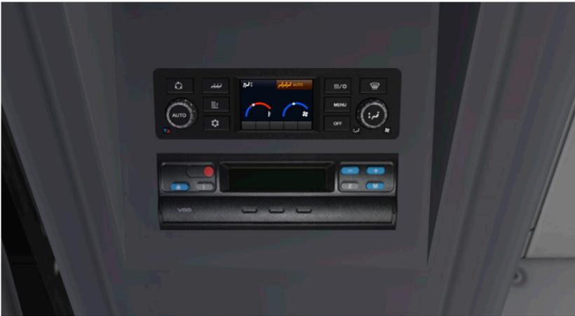
In den Sägezähnen über dem Fahrerplatz finden Sie das Klimabedienteil (siehe Heizung und Klimatisierung) und den Modultachografen (ohne Funktion).
