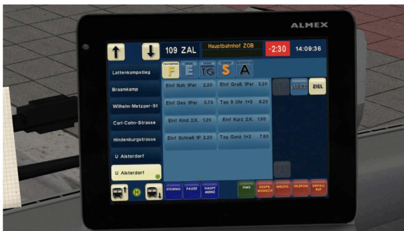
Beim ALMEX-Drucker („EFAD 2“) handelt es sich um einen modernen Touchscreen-Fahrscheindrucker, der auch eine RBL-Schnittstelle zur Steuerung der Haltestellenansagen und Zielanzeige bietet. Der Drucker wurde in Zusammenarbeit mit der HOCHBAHN entwickelt. Aufgrund der Vielzahl der Funktionen sind nur die wichtigsten im OMSI 2 umgesetzt, doch auch das sind eine ganze Menge.
