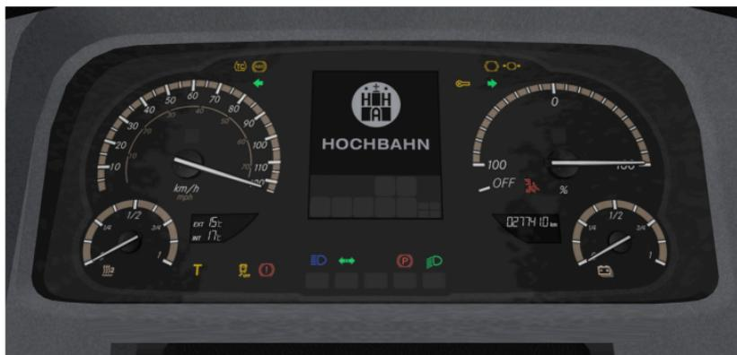
Wie die dieselbetriebenen Modelle verwendet auch der elektrische Bus ein kleines und farbiges Display. Außerdem gibt es über die Armaturen verstreute Leuchtsymbole, die einige Funktionen teilweise zusätzlich zum Display, teilweise allein anzeigen.
