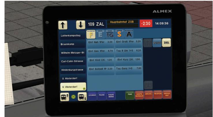
Beim ALMEX-Drucker („EFAD 2“) handelt es sich um einen modernen Touchscreen-Fahrscheindrucker, der auch eine RBL-Schnittstelle zur Steuerung der Haltestellenansagen und Zielanzeige bietet. Der Drucker wurde in Zusammenarbeit mit der HOCHBAHN entwickelt. Aufgrund der Vielzahl der Funktionen sind nur die wichtigsten im OMSI 2 umgesetzt, doch auch das sind eine ganze Menge.
