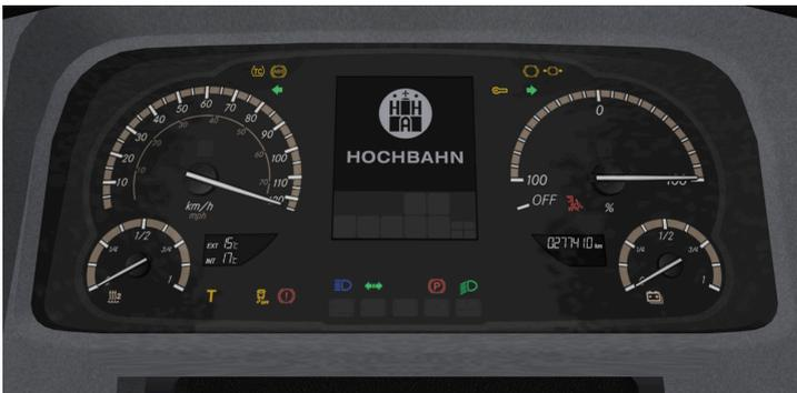
Wie die dieselbetriebenen Modelle verwendet auch der elektrische Bus ein kleines und farbiges Display. Außerdem gibt es über die Armaturen verstreute Leuchtsymbole, die einige Funktionen teilweise zusätzlich zum Display, teilweise allein anzeigen.
