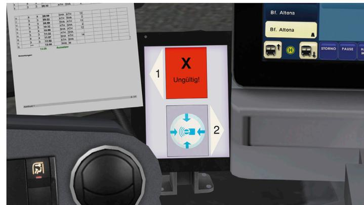
Das Fahrer-Kontrolldisplay des PVS ist zwischen Armaturenbrett und Fahrscheindrucker installiert. Ihnen wird dort angezeigt, ob der Fahrgast über eine gültige Karte verfügt. Außerdem können Sie, durch Klick auf eins der beiden Kontrollfelder, das jeweilige Terminal sperren.
