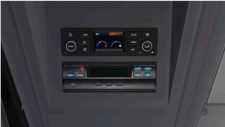
In den Sägezähnen über dem Fahrerplatz finden Sie das Klimabedienteil (siehe Heizung und Klimatisierung) und den Modular Tachografen (ohne Funktion).
